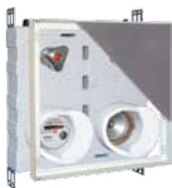
Fliesenabdeckung Typ FAP mit tiefenverstellbaren pulverbeschichteten (ähnlich weiß RAL9016) Halterahmen und befliester Schwenktür mit Wedi-Einlage sowie Push-Down-Verschluss
